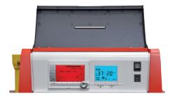
Die witterungsgeführte Regelung Œ-tronic 4® DIN lässt sich in das Kesselschaltfeld einbauen. Die Kommunikation mit dem Kessel erfolgt über das interne Bussystem. Durch dieses Datenbussystem ist es möglich, weitere Kessel oder Œ-tronic 4® DIN zu Kaskaden von bis zu 10 Einheiten zusammen zu schließen.
