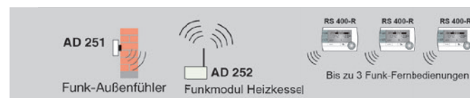
Die Fernbedienung RS 400 sowie der Außenfühler sind auch in der Variante RS 400-R mit Funkverbindung erhältlich.
