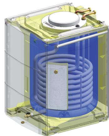
Brauchwasser Speichervolumen von 160 Litern mit Erwärmung durch einen Glattrohrwärmetauscher. Emaillierter Unterstell- bzw. Beistell-Hochleistungsspeicher, ausgerüstet mit einer Fremdstromanode untergestellt oder nebenstehend.
