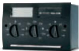
Die REA-Regelungen ermöglichen eine außentemperaturabhängige, witterungsgeführte Regelung der Heiztemperatur durch die Steuerung des Brenners und der Mischer (falls vorhanden). Die Regelungen wurden speziell für den Einbau in die Schalttafel der PKR 440-Heizkessel entwickelt.
