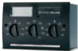
Die REA-Regelungen ermöglichen eine außentemperaturabhängige, witterungsgeführte Regelung der Heiztemperatur durch die Steuerung des Brenners und der Mischer (falls vorhanden). Die Regelungen wurden speziell für den Einbau in das Schaltfeld der PKR 540-Heizkessel entwickelt.
