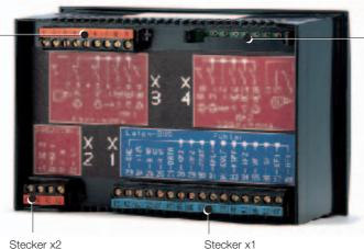
Stecker x1 Anschluß für Fühler, RFF 60-Fernbedienung und RES 11-
